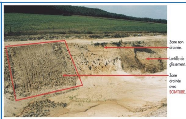
Figure 5. Comparaison avec ou sans géocomposite.
